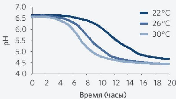
**Процесс ферментации eXact® Tvorog Plus 2**
